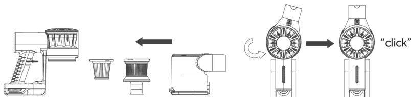
Encage el depósito correctamente, asegurándose de que la parte inferior del depósito esté bien colocada en la unidad motora.
