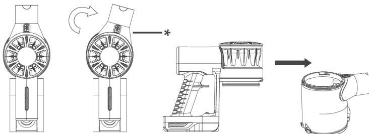
Para libertar o filtro metálico da unidade motora, rode-o para a esquerda.
