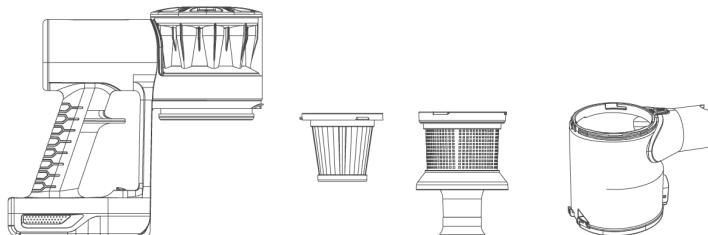
Lave o depósito e os filtros com água. Não utilize solventes, produtos com um fator pH ácido ou básico como a lixívia, nem produtos abrasivos pois pode danificar os componentes..
