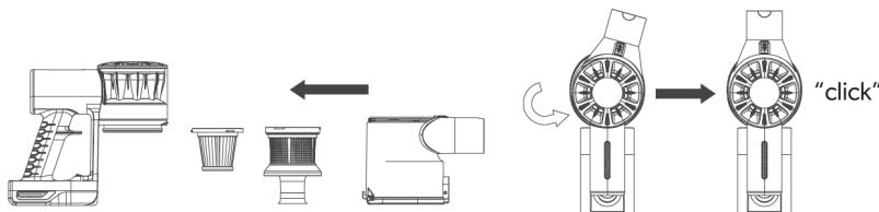
Encaixe o depósito corretamente, certificando-se que a parte inferior do depósito está encaixada na unidade motora.
