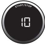
Jos haluat hallita sekoittamisen nopeutta ja rakennetta täydellisesti, valitse manuaalinen tila. Paina MANUAL (manuaalinen), valitse haluamasi ohjelma kääntämällä säädintä ja paina sitten START/STOP (käynnistä/pysäytä). Nopeus on käytössä yhtäjaksoisesti 60 sekunnin ajan. Jos haluat pysäyttää ohjelman aiemmin, paina säädintä uudelleen. Manuaalisia ohjelmia ei voi käyttää BlendSense-ohjelman tai sekoitustilaohjelmien yhteydessä.
