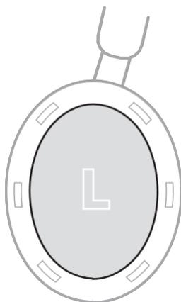
4. Alinhe as seis abas na flange de montagem da almofada com as seis ranhuras no auricular e, em seguida, pressione a almofada até que todas as seis abas encaixem em cada ranhura. Ouvirá e sentirá um clique quando a almofada estiver corretamente posicionada.
