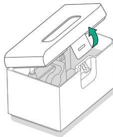
3 Esvazia o Reservatório de Água Suja. Enche o Reservatório de Água Limpa com água.
